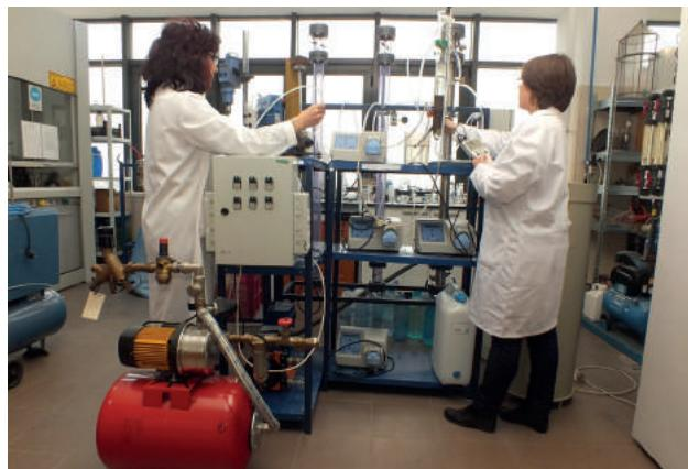
**Echipamente de cercetare pentru dezvoltarea/demonstrarea experimentală la nivel de laborator a tehnologiilor de tratare/epurare a apelor în scop potabil/a apelor uzate** (bio/foto/reactoare, dispozitive on-line/off-line de monitorizare, etc.).
