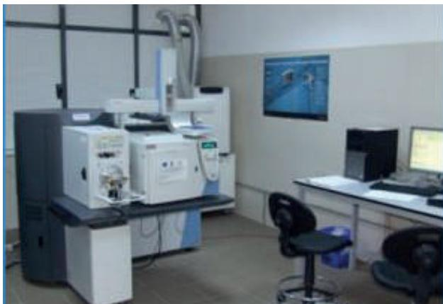
**Gaz chromatograf cu spectrometru de masa cu inalta rezolutie** (determinare dioxine si furani din emisii atmosferice, namol, sol).
