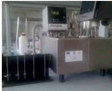
Vascozimetru cu rotor si baie termostatata
