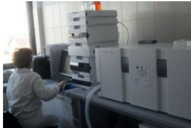
**Cromatograf de lichide cu detector spectrometru de masa triplu cuadrupol** (determinare medicamente, poluanți inclusi în lista substanelor prioritare).
