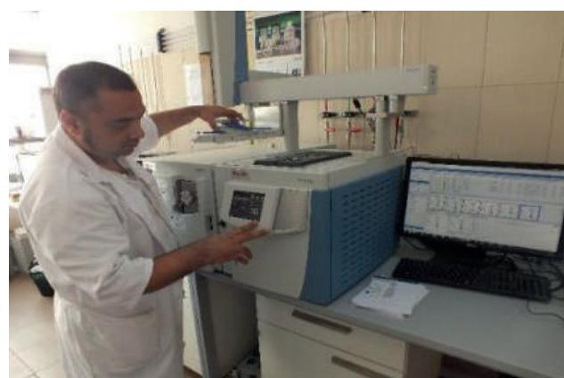
**Sistem automat de extractie in faza solida** (extractia compusilor organici din probe de apă).
