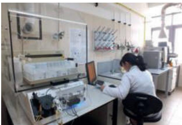
**Spectrometrul de fluorescenza atomica** (determinare mercur din probe de apă la nivel de ng/L).
